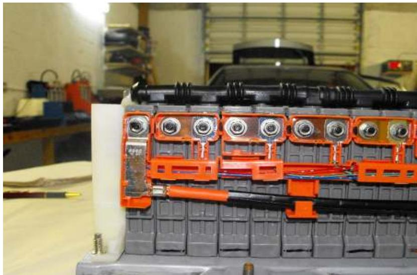
Este voltaje es entonces el que a continuación será utilizado en los motores trifásicos que son el motogenerador MG1, el motogenerador MG2 y el motor del aire acondicionado. Todos estos serán explicados detalladamente más adelante, pero este voltaje requiere ser también restablecido y monitoreado constantemente por la ECU de la batería, adicionalmente la batería debe mantenerse a temperatura que no ocasione problemas.
