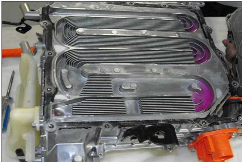
La conexión de alta tensión en el sistema se efectúa a través de conectores (de color Naranja). Su diámetro y conectores son especialmente diferentes a cualquier sistema convencional. Siempre que se trabaje en un sistema de este tipo se recomienda seguir detenidamente las especificaciones del fabricante, en la imagen inferior se puede observar uno de estos conectores, en este caso el que proviene de la batería de alta tensión HV y entra al conjunto del INVERSOR.
